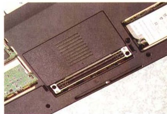
Lo slot di approdo alla dock-bay si apre automaticamente.
